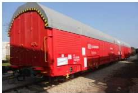
Bild 2: Dach in Transportstellung G1
