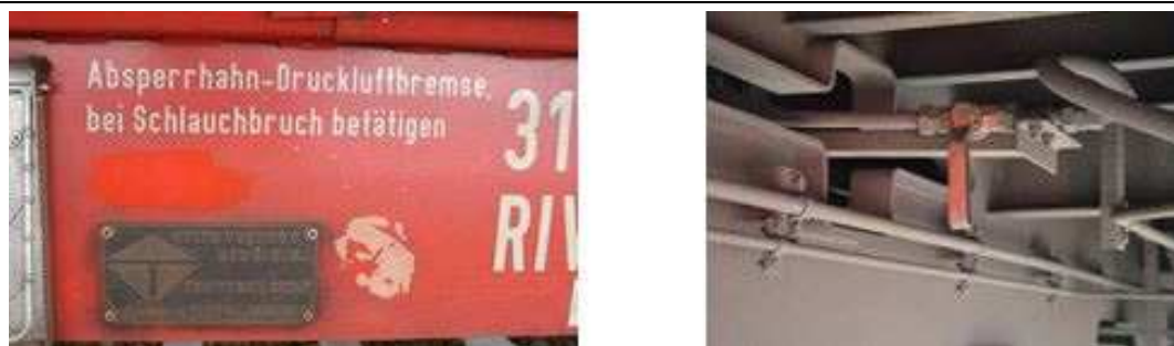
Bild 3: Erreichbarkeit des zusätzlichen Luftabsperrhahnes
