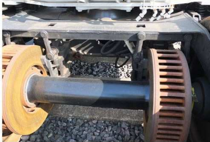
Radsatzwelle mit zwei Bremsscheiben und Bremsgestängen
