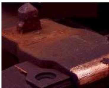
Bild 2: Aufsetzzapfen klappbar, hochgeklappt
