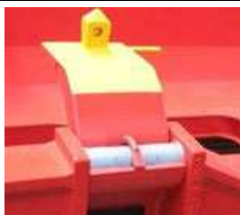
Bild 4: Aufsetzzapfen klappbar, hochgeklappt
