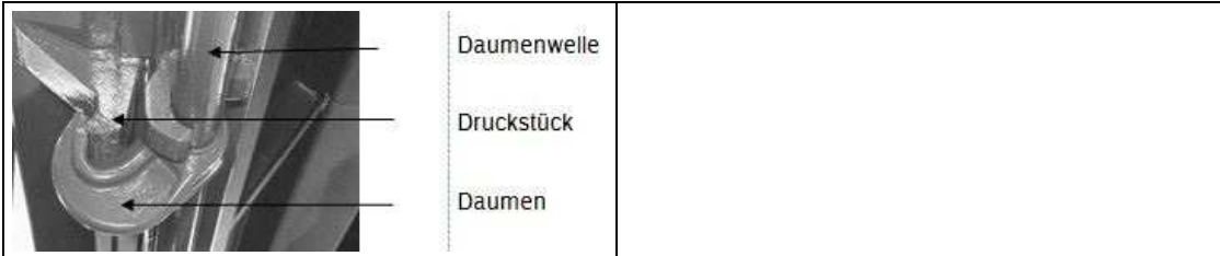
Bild 5: Klappenverschluss: Die Daumen müssen das Druckstück umfassen.
