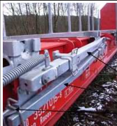
Bild 4: Rungen in heruntergeklappter Position
