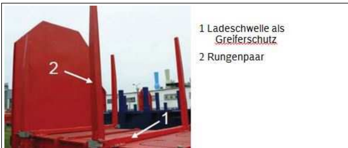
Bild 2 Rungenpaar mit dazwischen liegender Ladeschwelle
