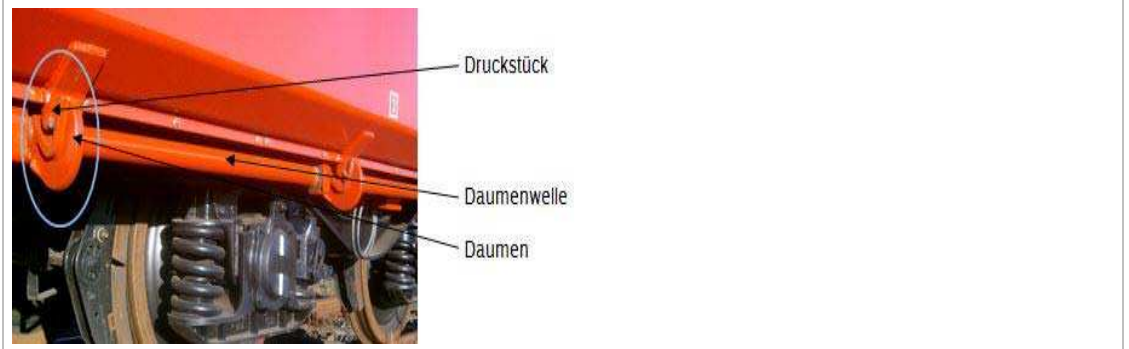
Bild 3: Überdeckung des Daumenwellenverschlusses bei geschlossener Klappe
