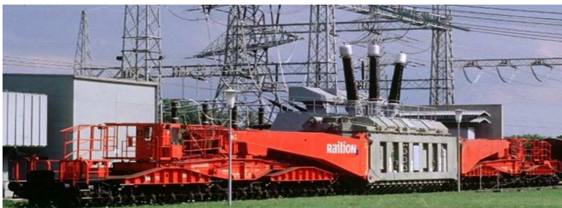
Bild 2: Uaai 839 (32 RS) beladen mit selbsttragenden Ladegut (Transformator)
