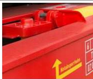
Bild 3: Aufsetzzapfen klappbar, abgeklappt
