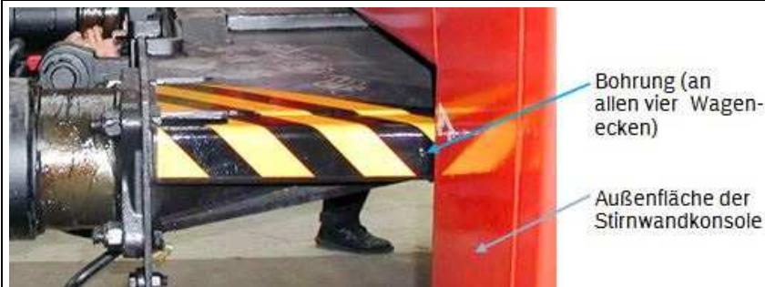
Bild 3: Gleitträger in Normallage
