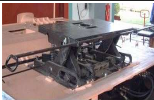
Trichter mit ausreichender Schmierung und ohne erkennbare Schäden
