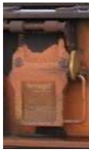
Bild 3: Aufsetzzapfen klappbar, abgeklappt und gesichert
