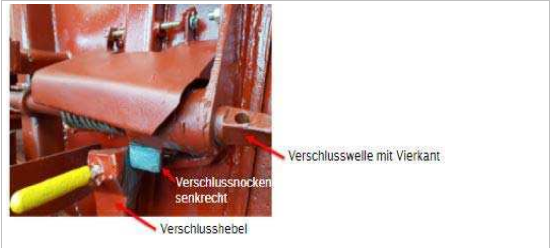
Bild 2: Verschlusswelle: Seitenklappe geschlossen und verriegelt. Der Verschlussnocken muss sich augenscheinlich in senkrechter Stellung befinden. Die Seitenklappen müssen geschlossen sein, dabei müssen sich die Verschlusshebel jeweils hinter den federnden Verschlussnocken befinden
