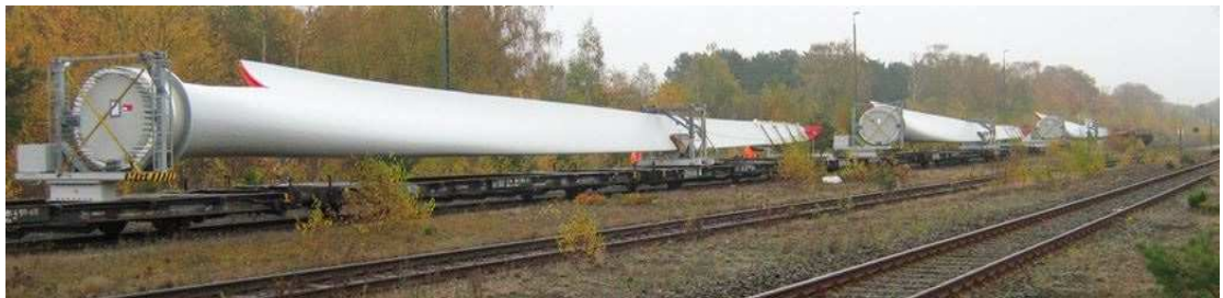
Bild 2: Uiks 635 beladen mit Rotorblättern
