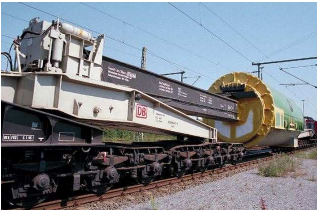
Bild 2: Uaai 837 Lastträger mit Generator
