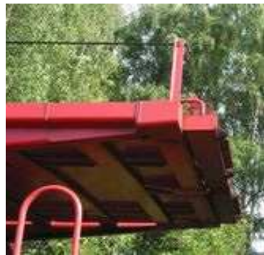
Bild 5: Stellung der Überfahrbrücke für Transporte bei total abgesenkter oberer Ladebühne (außer Bauart Laekks 551) zur Einhaltung des „Berner Raumes“ für den Rangierer zum Kuppeln Die gesamte Überfahrbrücke muss nochmals um 90° hochgeklappt werden.
