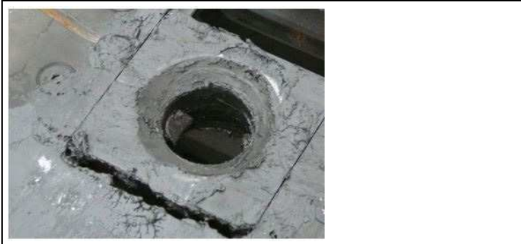
Trichter mit ausreichender Schmierung und ohne erkennbare Schäden
