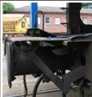
Bild 3: Untere Überfahrbrücke in Verladestellung
