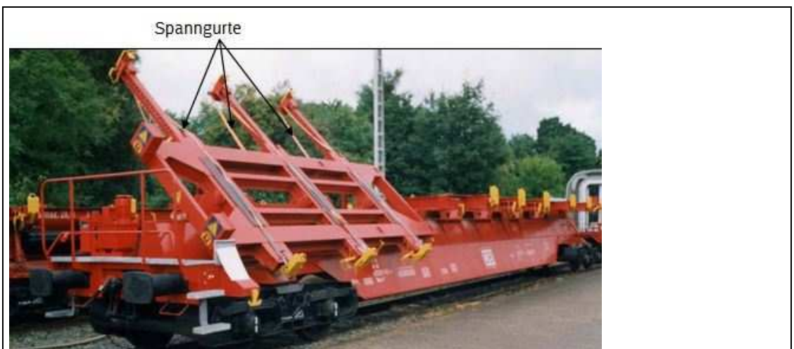
Bild 2: Schrägstellung eines Ladegerüstes
