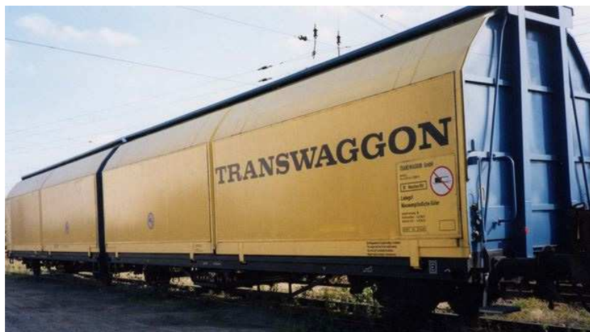
Bild 5: Schiebewandwagen mit Betätigung in Hebelausführung (Querbetätigung)
