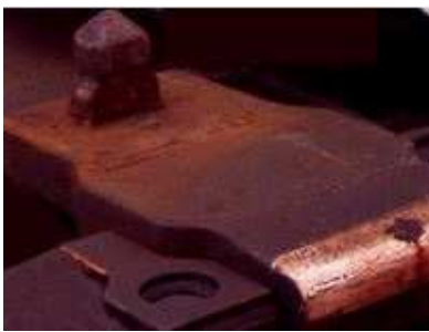
Bild 2: Aufsetzzapfen klappbar, hochgeklappt
