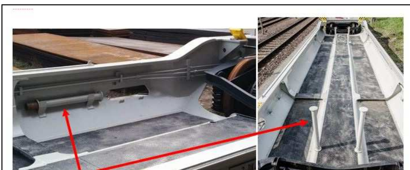
Wechselbehälterstütze in Ablageposition an der Innenseite des Langträgers und in Stützposition in der Ladetasche
