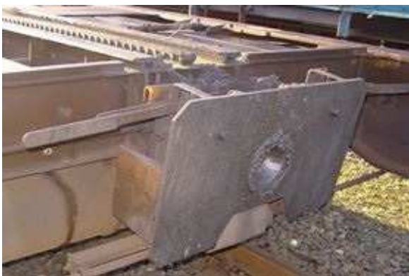
Bild 4: Stützbock auf Stützbockklapptisch, abgeklappt
