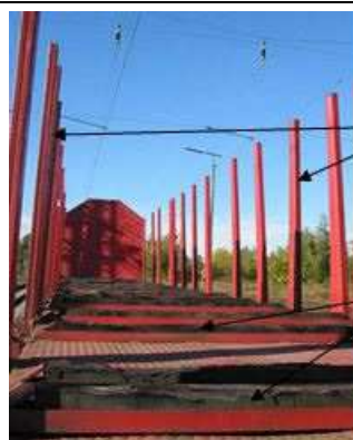
Bild 5: Unbelastete Rungen stehen nach innen
