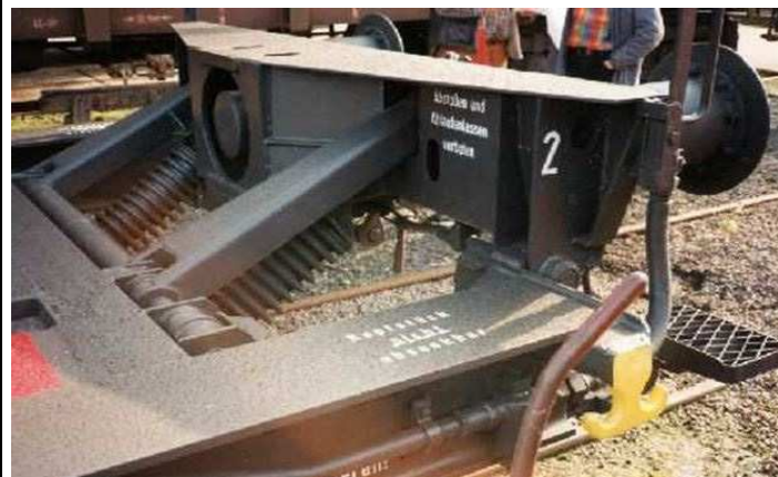
Bild 5: Wagenende mit hochgestelltem Kopfstück (hydraulische Betätigung)
