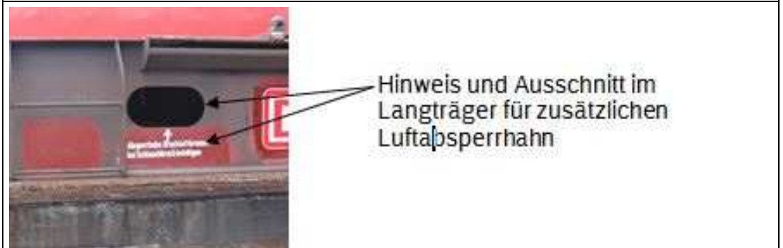
Bild 3: Erreichbarkeit des zusätzlichen Luftabsperrhahnes
