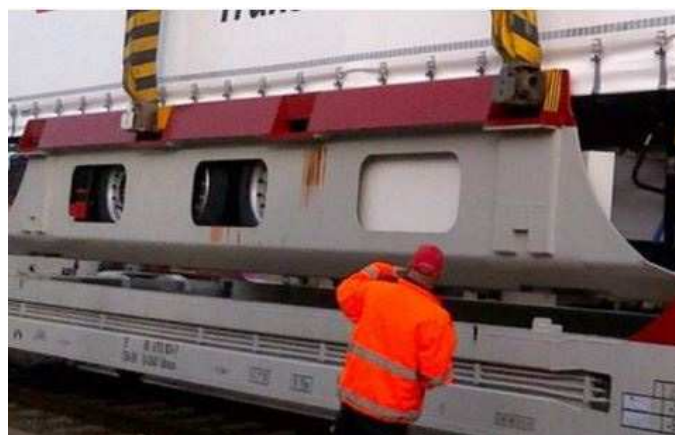
Be- und Entladung mittels Portalkran (Bild 9)
