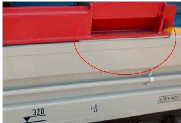
Untersuchungskriterium: „Waggonaufsatz“ muss auf der Seitenwand aufsitzen. (Bild 5)
