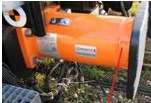
Angesprochener Crashpuffer, gelber Pfeil nicht erkennbar, Pufferhülse leicht deformiert.
