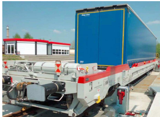
Kontrolle der waagerechten Lage des SAnh nach der Beladung. (Bild 8)
