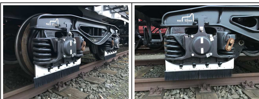
Aluminiumplatte mit Borsten- Vorhang am Radsatz
