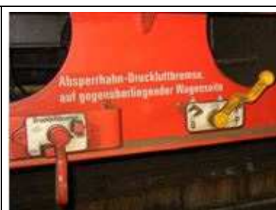
Bild 6: Hinweis auf Absperrhahn auf gegenüberliegender Wagenseite
