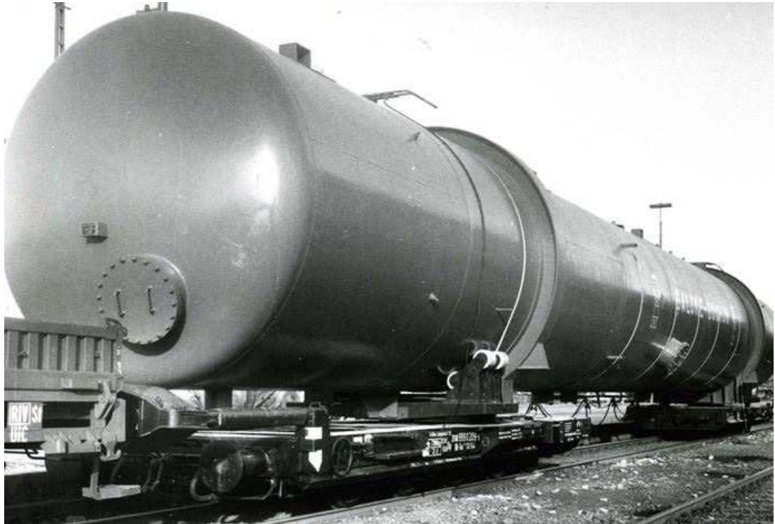
Bild 1: Uaai 812 mit getrennten Wagenhälften und mit einem Druckkessel beladen
