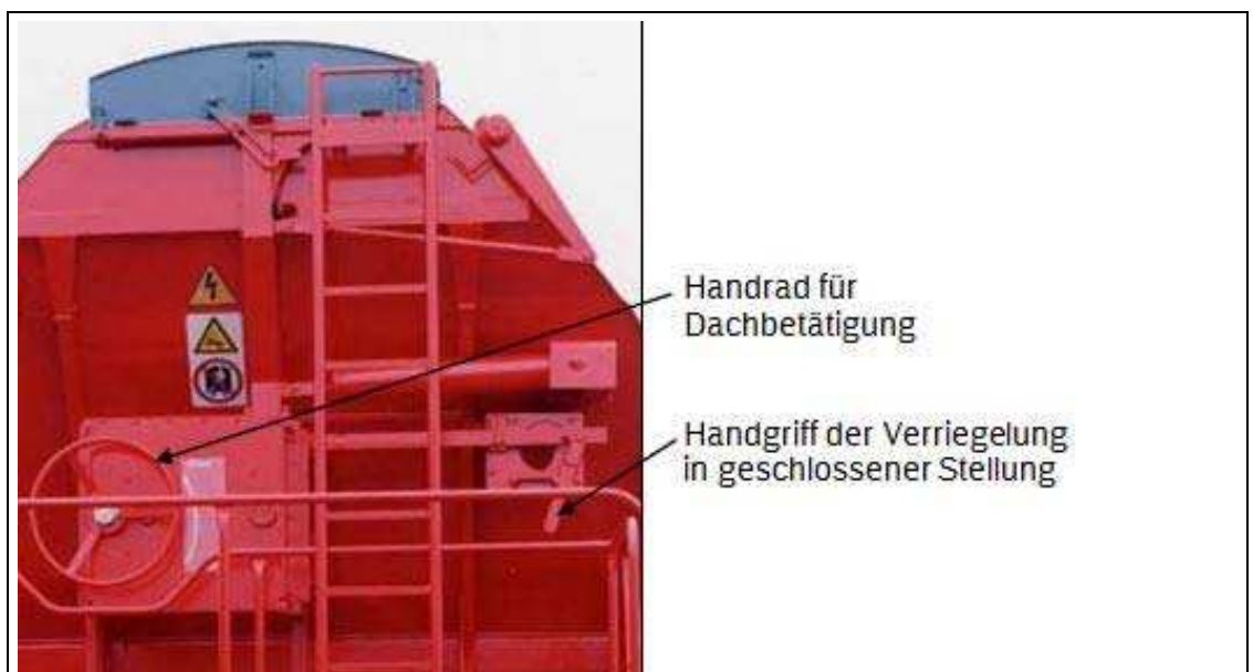
Bild 5: Schwenkdach geschlossen und verriegelt (Transportstellung)
