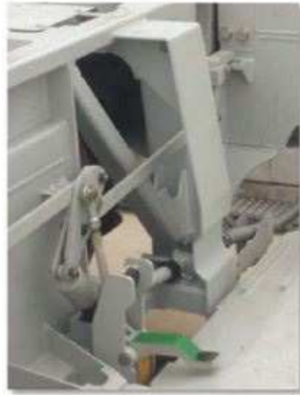
Korrekte Position des Fußhebels bei verschlossener Seitenwand (Bild 4)
