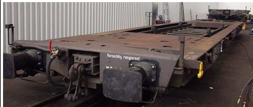
Bild 4: Wagenende mit abgesenktem Kopfstück (hydraulische Betätigung)
