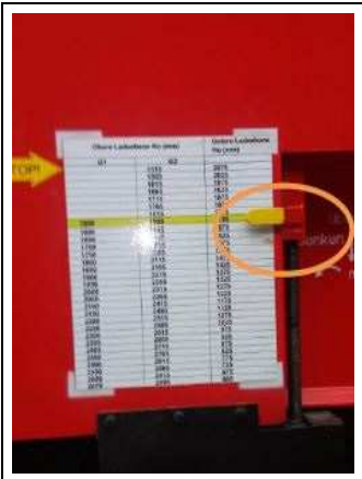
Bild 3C: Obere Ladeebene in Transportstellung G2
