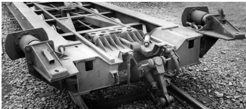
Bild 3: Uaais 754 mit ausgeschwenkten Puffern und abgesenkter Zugeinrichtung
