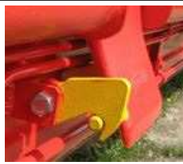
Bild 5: Aufsetzzapfen abgeklappt und gesichert
