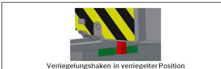
Bild 15: Rollbalken Verriegelungshaken im Eingriff
