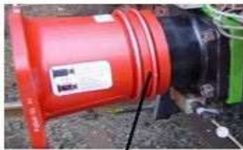
Crashpuffer (AXTONE) nach starker Überschreitung der Auslösekraftschwelle. Gelbe Pfeilmarke ist nicht mehr sichtbar, Pufferhülse stark deformiert.
