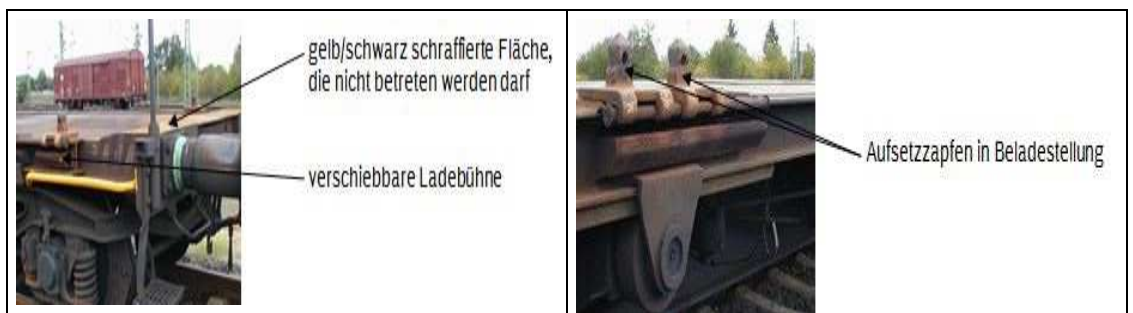
Bild 3: Wagenende mit gelb/schwarz schraffierte Flächen, die nicht betreten werden darf
