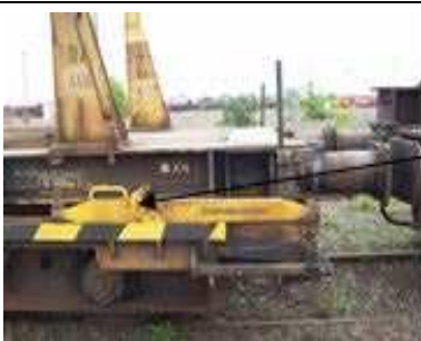
Bild 2: Durch Sicherungshaken gesicherte Überfahrschiene
