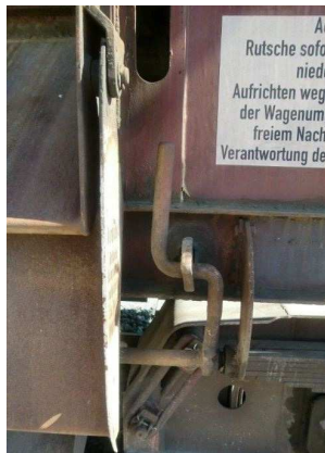
Bild 7: Bedienungseinrichtungen der unteren Zusatzrutschen
