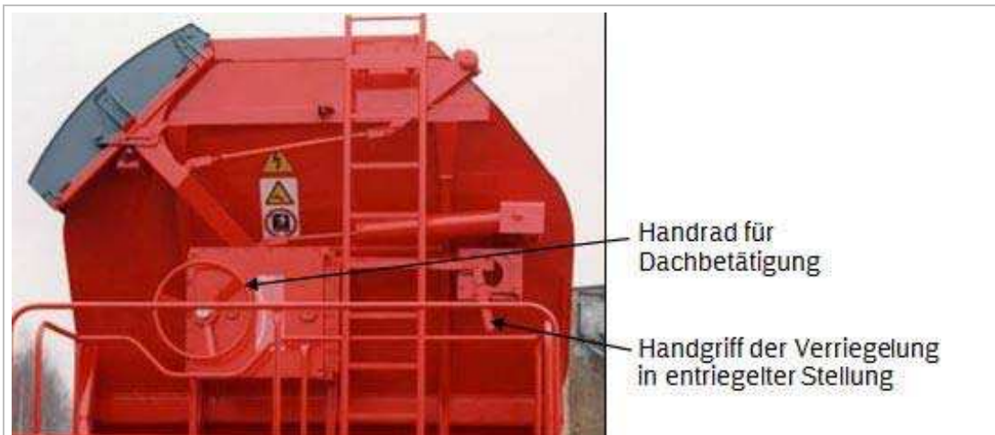
Bild 6: Schwenkdach geöffnet und entriegelt (Beladestellung)
