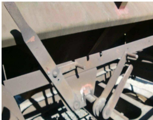
Bild 6: Bedienungseinrichtungen der oberen Zusatzrutschen
