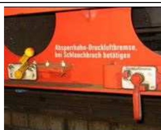
Bild 4: Ausschnitt im Langträger zum Erreichen des Luftabsperrhahnes
