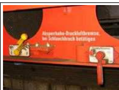
Bild 5: Ausschnitt im Langträger zum Erreichen des Luftabsperrhahnes
