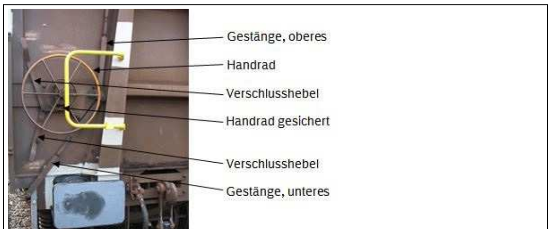
Bild 2: Handrad befindet sich in der Endstellung und ist durch federnd gelagerten Verschlusshebel gesichert.
