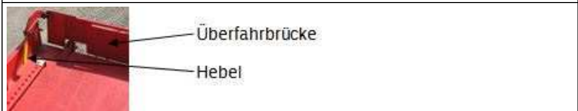
Bild 3: Obere Überfahrbrücke in Transportstellung
