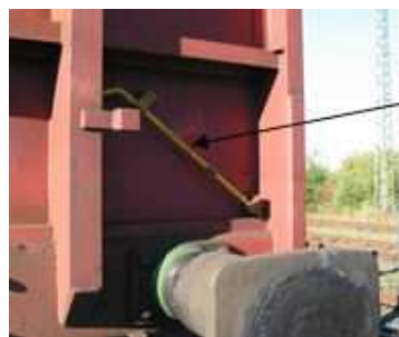
Bild 4: Ablage des Bedienhebels zur Arretierung der Rungen
