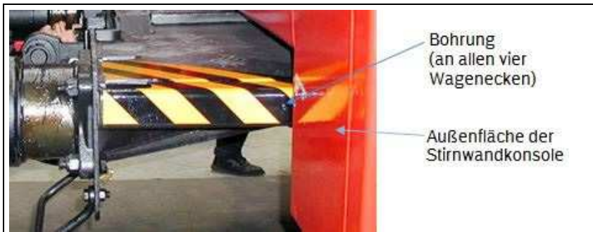
Bild 2: Gleitträger in Normallage
