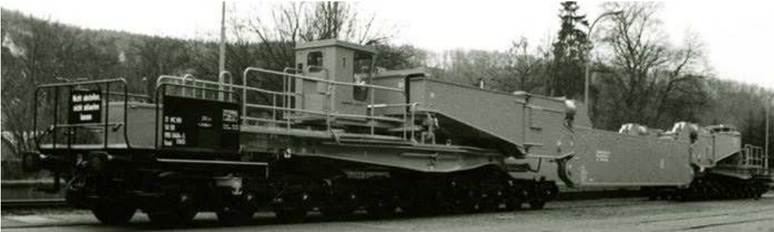
Bild 1: Uaai 831, 20-achs.Tragschnabelwagen mit Durchladelängsträger (DLT)
