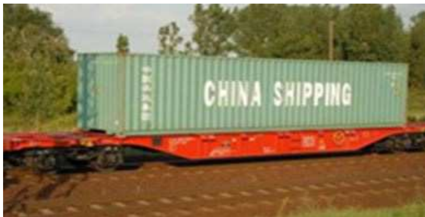
Sgns 696 (Vierachsige Tragwagen für Großcontainer und Jumbo-Wechselbehälter) mit Kompaktbremse, CFCB-Light der Firma Knorr-Bremse.
