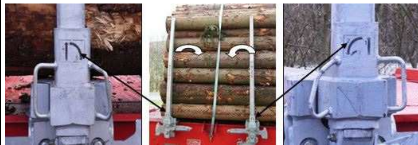
Bild 3: Nebeneinander angeordnete herunterklappbare Rungen
