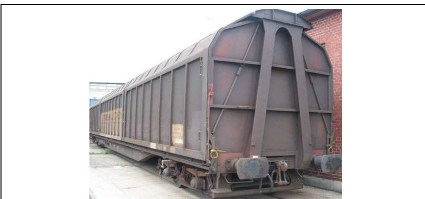
Bild 2: Schiebewandwagen mit Betätigung in Hebelausführung (Querbetätigung)
