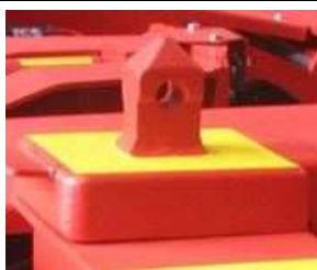
Bild 2: Aufsetzzapfen klappbar, hochgeklappt
