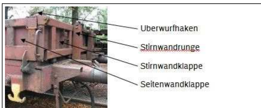
Bild 3: Hochgestellte und durch Stirnwandrungen und Überwurfhaken gesicherte Stirnwandklappe (Ks-Wagen)
