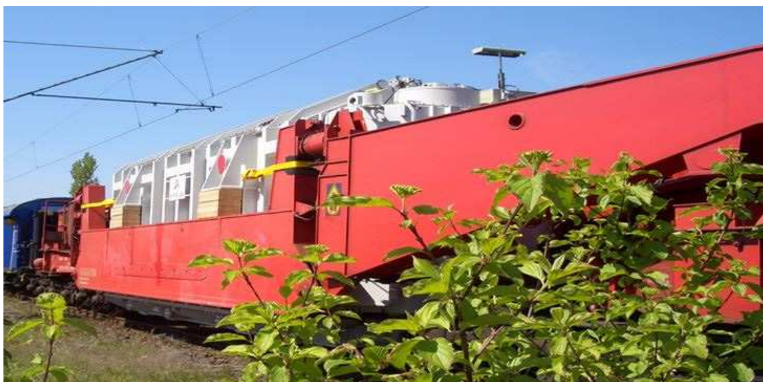
Bild 1: Uaai 838 (24 Rs) beladen mit Durchladelängsträger (DLT) und Transformator
