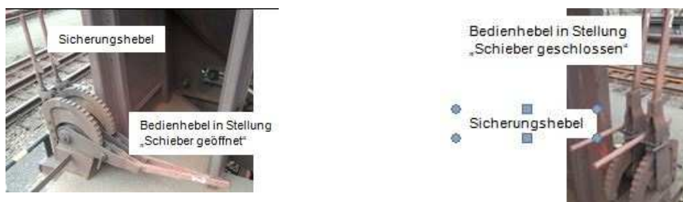
Bild 2: Handhebel für Rundschiebebetätigung
