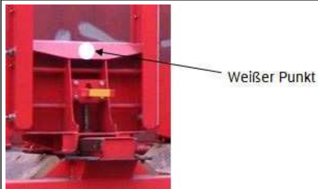
Bild 3: Kennzeichnung „Weißer Punkt“ (leicht verschiebbar) an einem umgerüsteten Rungenschlitten (Beispiel wie Rils-y 649)
