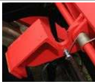
Bild 7: Mittenunterstützung klappbar, abgeklappt
