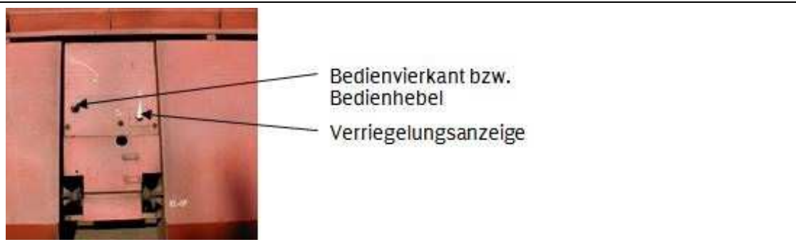
Bild 2: Bedienung und Anzeige „Klappen geschlossen“ in Wagenmitte
