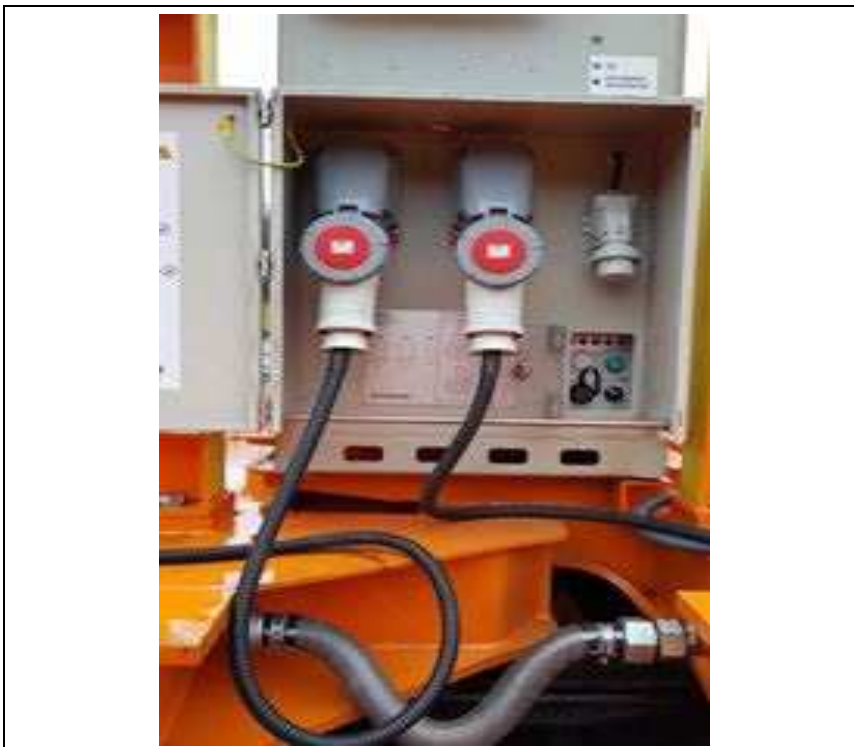
Verteilerschrank für erforderliche Steckverbindungen im geöffneten Zustand T 3000 mit Energieversorgung
