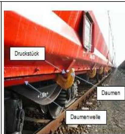
Bild 5: Klappenverschluss
