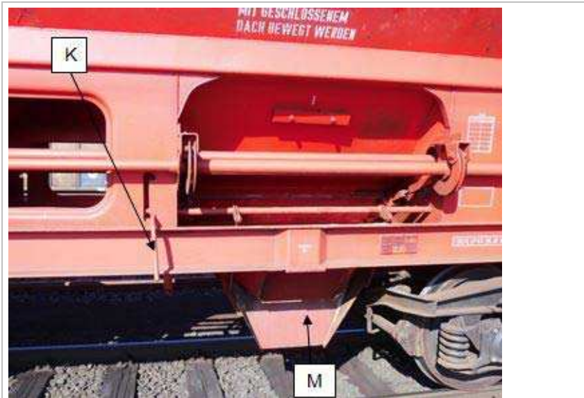
Bild 6: Einschwenken und Verriegeln der Zusatzrutsche
