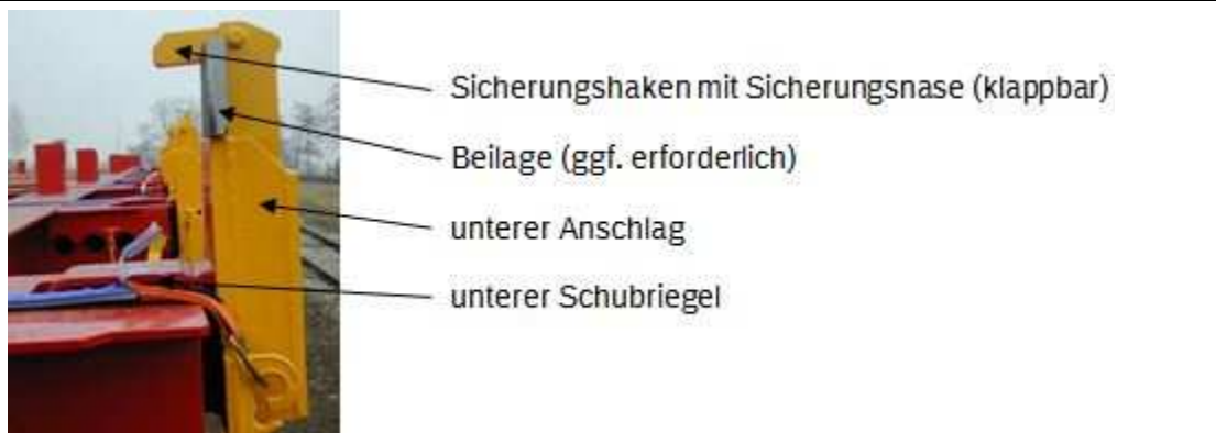
Bild 6: Sicherungshaken am unteren Schubriegel
