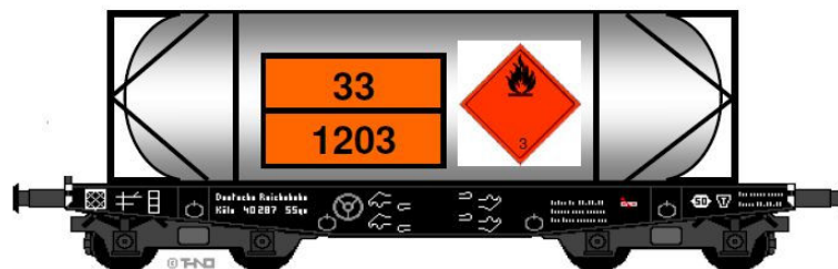
Bild 3 Tankcontainer Ladegut: Benzin
