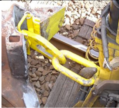
Bild 6: GZK in Kurzkuppelstellung
