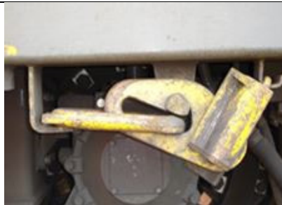
Bild 9: GZK- Halterung am AK-Übergangswagen
