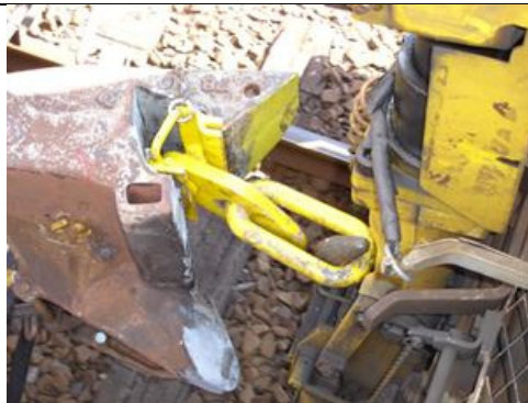
Bild 6: GZK in Kurzkuppelstellung
