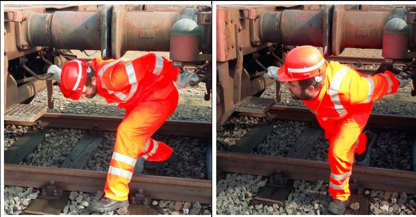
Heraustreten aus dem Kuppelraum
