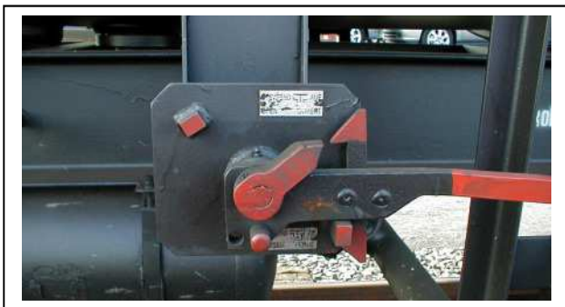
Abb. 12 Ventilstellungszeiger zeigt geöffnetes Bodenventil
