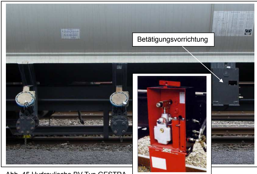
Abb. 45 Hydraulische BV Typ GESTRA
