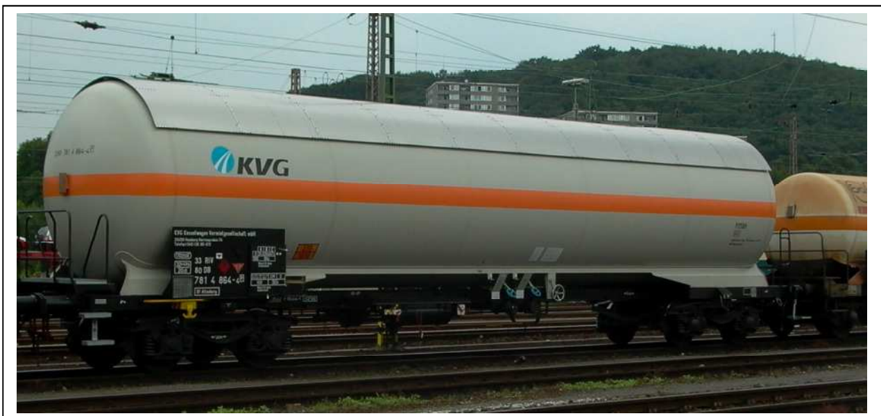
Abb. 29 Druckgaskesselwagen mit Untenentleerung
