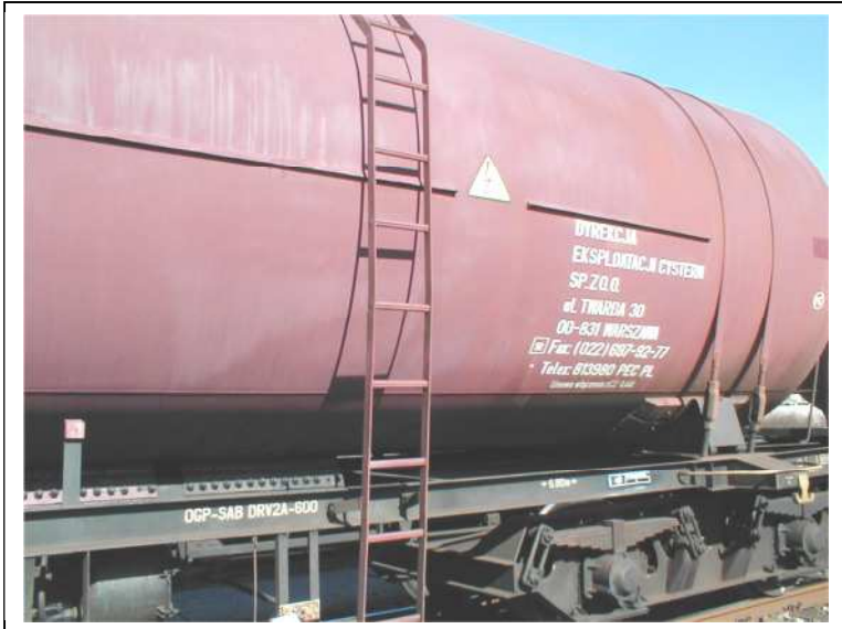
Abb. 2 Tankbefestigung mittels Spannbändern und tankmittiger Aufsattelung
