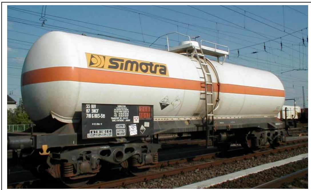
Abb. 47 Druckgaskesselwagen mit Obenentleerung
