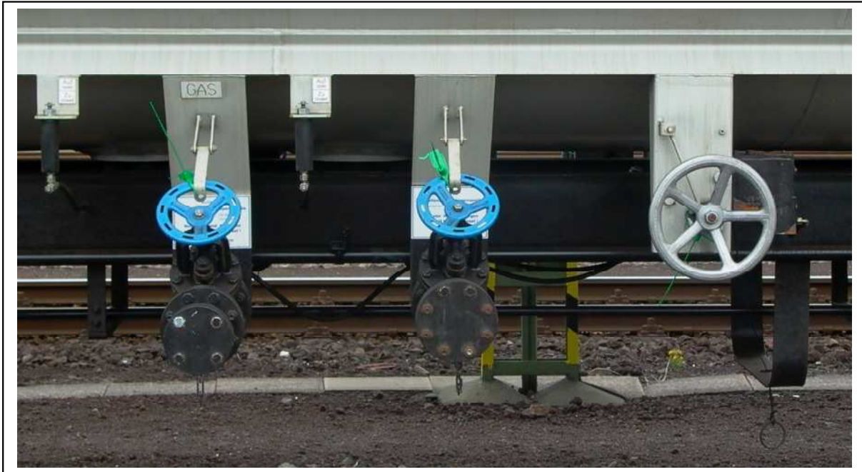
Abb. 42 hydraulisch betätigte BV Typ EVA
