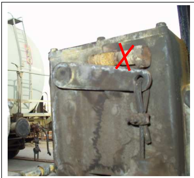
Abb. 44 Straffseilhebel in manipulierter Stellung
