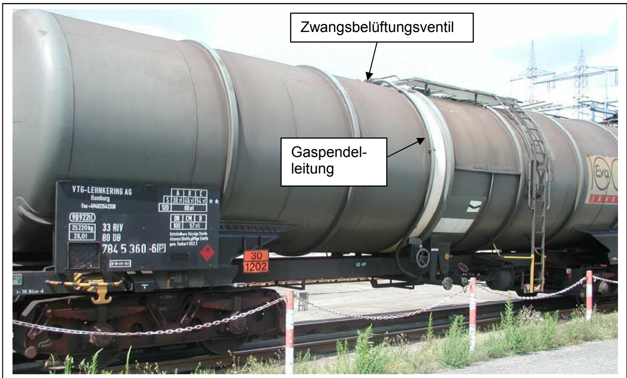
Abb. 7 Mineralölkesselwagen mit Zwangselüftungsventil und Gaspendelleitung
