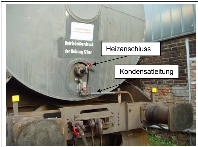
Abb. 22 Heizanschluss eines EKW
